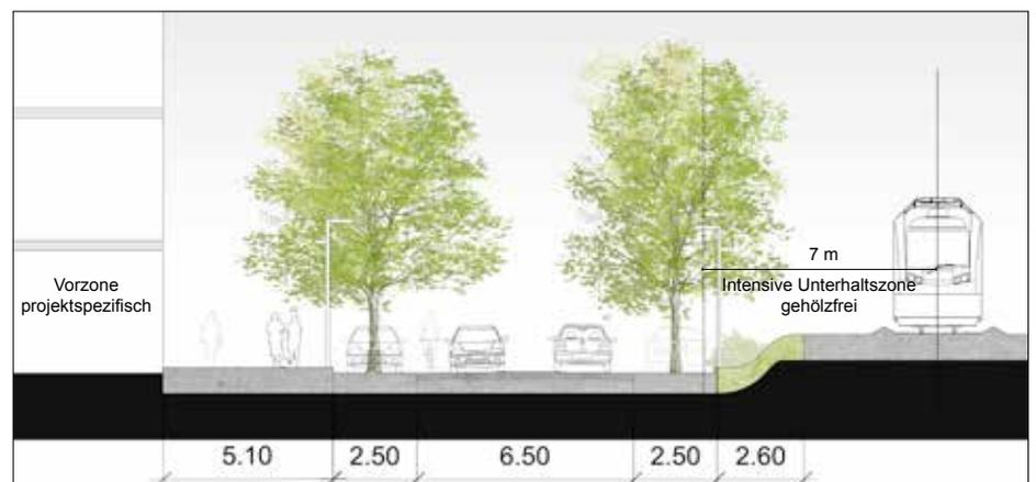
Abb. 39: Querschnitt Industriestrasse
